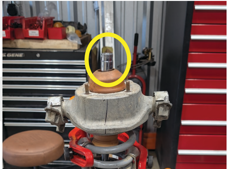
Remove top hat bolt 18/19mm
